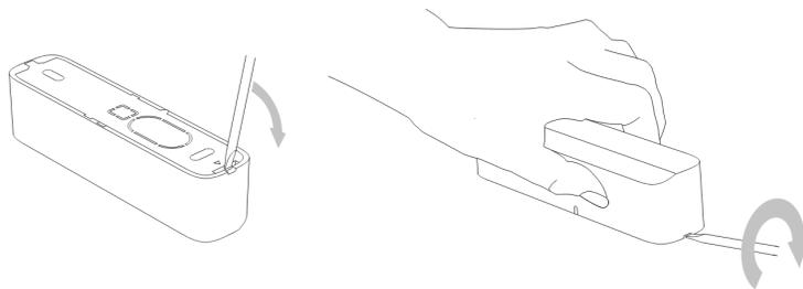
Для подключения внешнего датчика используйте шлейф, входящий в комплект поставки. Внешний датчик обрабатывается охранным прибором как отдельная зона. Его настройка осуществляется через конфигуратор охранного прибора.
