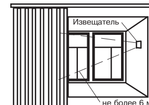
Рисунок 8 – Установка извещателя между стеклом и занавесями (жалюзи)
