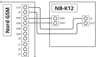
К охранным приборам Норд GSM 5.х подключаются максимум 3 клавиатуры. К приборам Nord GSM/WRL/Nord Pro/Nord Pro Air подключаются до 5 клавиатур.
