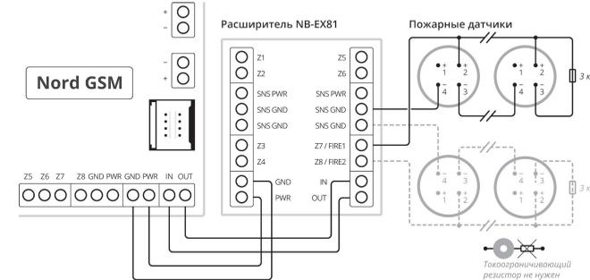
Длина линии связи ограничена сопротивлением кабеля. Для кабеля типа КСПВГ 4x0,2 с сопротивлением одной жилы 95 Ом/км максимальная длина линии составит 1050 метров. Убедитесь, что фактическое сопротивление используемого кабеля соответствует маркировке.
